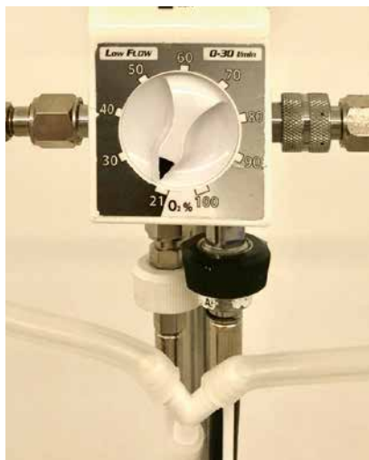
Figura 7. Mezclador de aire y oxígeno.
